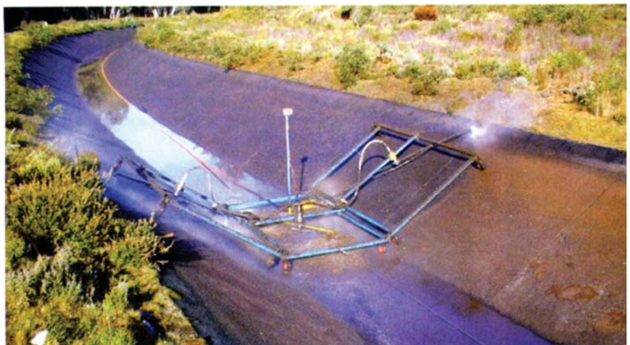
این کانال پاک کن که دارای جت آب مجهز به بازوهای گردان نصب شده در یک قایب است در اوایل سال ۲۰۰۵ در کانال آب رسانی به نیروگاه ۹۳۰،۶ مگاواتی تارالیه آزمایش شد. هر پاک سازی باعث بهبود جریان به میزان کمیوم شد.
